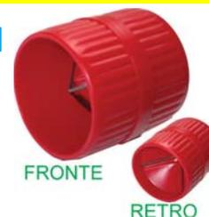
Tipo per svasare interno/esterno tubi di rame, ottone, leghe leggere, PVC, Ø mm 4 a 40. Corpo in lega di alluminio ad alta resistenza, coltelli in acciaio temprato.
